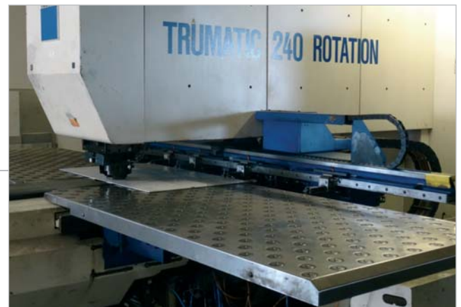
Découpe de tôles par poinçonnage
