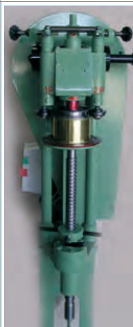
0539 Semi-automatique Pour boîtes rondes de Ø38mm à 153mm Hauteur maxi : 270mm
