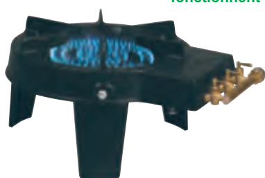
Réf 0377 : Prof.42cm - Ø.33cm - H.20,5cm - P.8,5Kg Puissance : entre 8,2 et 9,2 Kw suivant le gaz Rampe à 3 robinets en laiton
